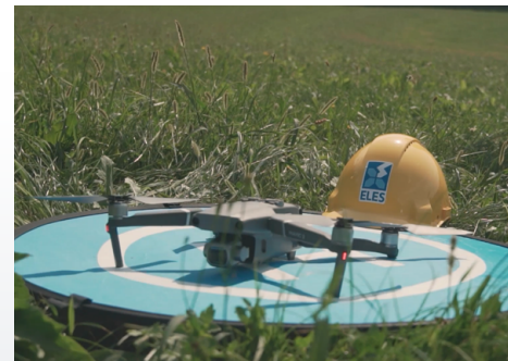
Oprema za avtomatizirano letenje dronov in podporo pri digitalnih pregledih VN infrastrukture
