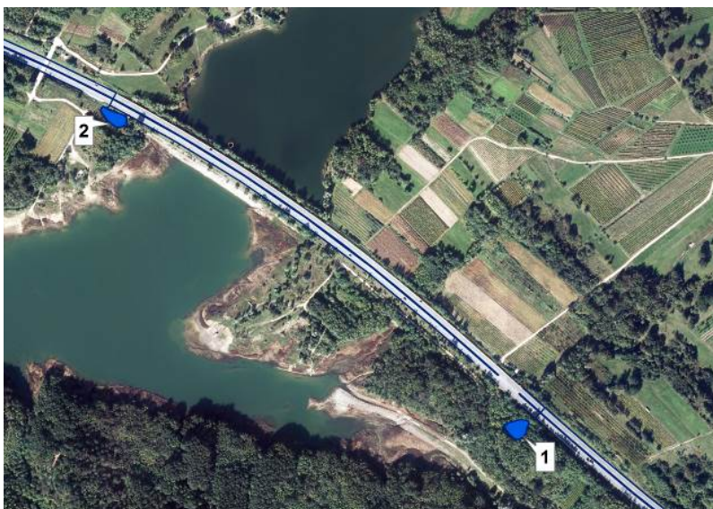
Slika 22: Shema cestne kanalizacije (modre linije) ter dva zadrževalnika meteornih vod z lovilci olj (1, 2) na območju zadrževalnika Vogršček (graf. podl.: DOF, 2010; ZK GJI, 2012) Figure 22: Road sewerage scheme (blue line) and two rainwater reservoir with oil separators (1, 2) in the area of the reservoir Vogršček (cartogr. basis.: DOF, 2010; ZK GJI, 2012)
