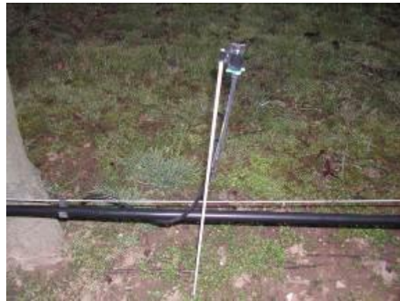
Slika 52: Stoječi dinamični kompenzacijski mikrorazpršilec.
