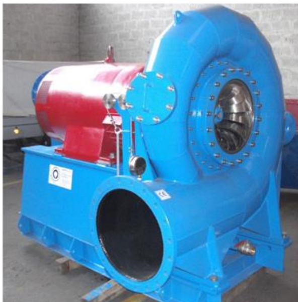
Sl. 10: Primer Francisove turbine oziroma spirala turbine in generatorja (obravan rdeče), [9]
