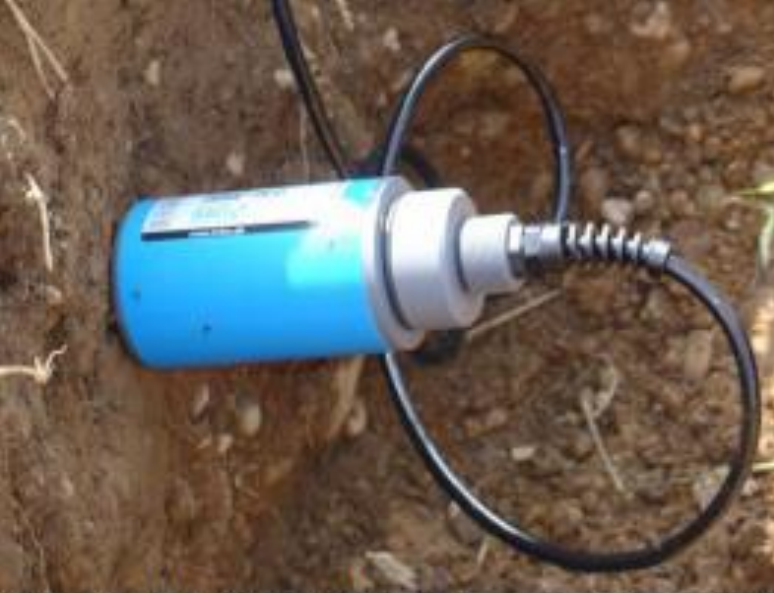
Slika 2: Merilnik TRIME-EZ, nameščen v tleh.
